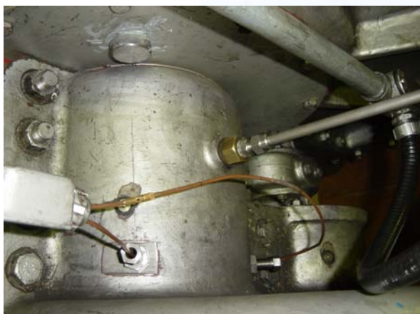
Detalhe de instalação dos sensores de proximidade série VK.
