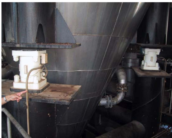
Detalhe de instalação dos sensores. Parte integrante da estrutura existente
