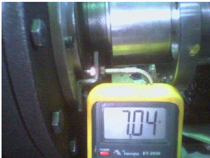
Detalhe de instalação dos sensores de proximidade série WK
