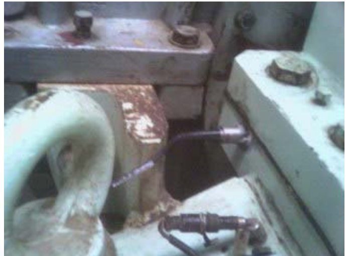
Detalhe de instalação dos sensores de vibração tipo acelerômetro modelo AC-122
