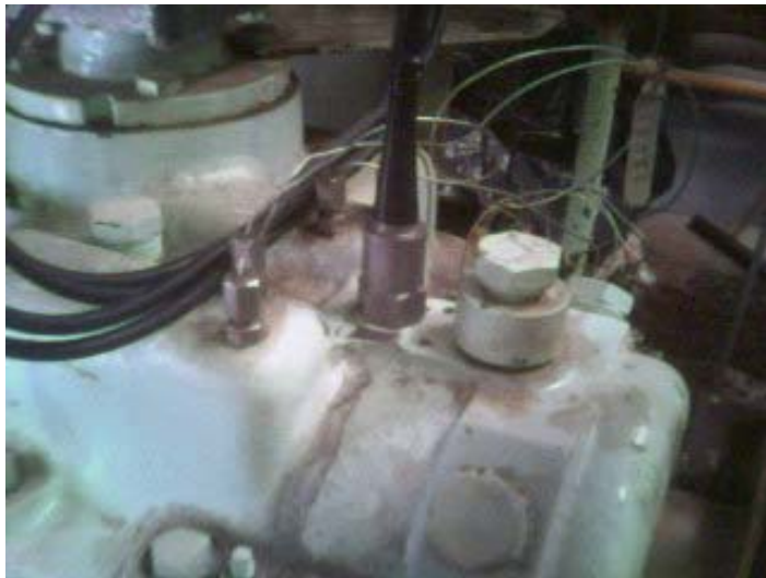
Detalhe de instalação dos sensores de vibração tipo acelerômetro modelo AC-122
